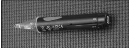
Figure 2 - Utiliser un multimètre sans contact pour confirmer que l'alimentation électrique est coupée avant de travailler sur un circuit.
