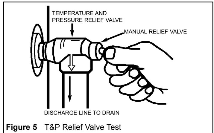
Figure 5 T&P Relief Valve Test
