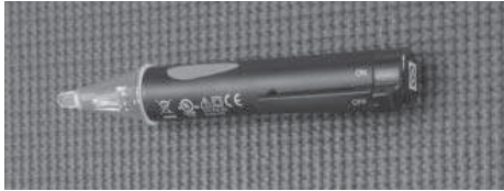
Figure 2 - Utiliser un multimètre sans contact pour confirmer que l'alimentation électrique est coupée avant de travailler sur un circuit.
