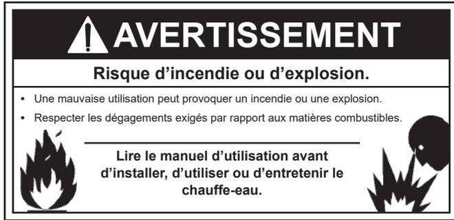
Les distances minimales par rapport aux matériaux combustibles sont indiquées sur la plaque signalétique à l'avant du chauffe-eau. Les dégagements standard sont de 0 mm (0 po) sur les côtés et l'arrière, de 0 mm (0 po) sur l'avant et de 0 mm (0 po) sur le dessus. Si les dégagements par rapport aux matériaux combustibles indiqués sur le chauffe-eau sont différents des dégagements standard, installer le chauffe-eau conformément aux dégagements indiqués sur le chauffe-eau.
