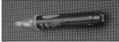
Figure 21 - Utiliser un multimètre sans contact pour vérifier l'alimentation électrique.
