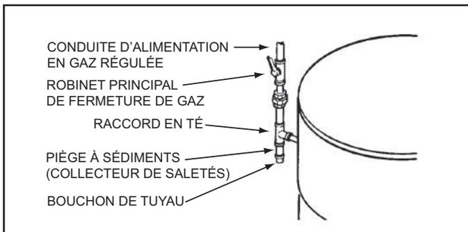
S'assurer que tout le tuyau de gaz est propre à l'intérieur avant l'installation. Pour piéger toute saleté ou tout corps étranger dans la conduite d'alimentation en gaz, un bac de sédimentation (collecteur de saletés) doit être installé comme l'indique la Figure 52. Le piège à sédiments doit être facilement accessible et ne pas être soumis aux conditions de gel. Installer conformément aux recommandations de compagnie du gaz locale.
