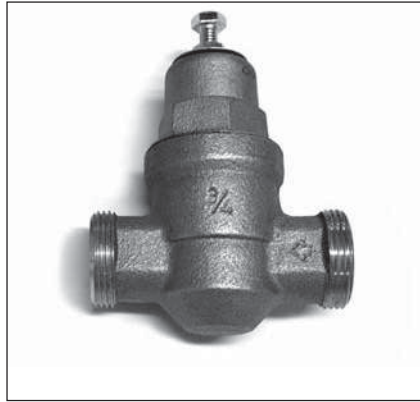
Figure 15 - Un réducteur de pression est nécessaire si la pression d'eau du bâtiment est supérieure à 552 kPa (80 psi).
