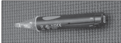
Figure 21 - Utiliser un contrôleur de tension sans contact pour vérifier l'alimentation électrique.
