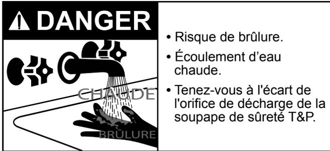
Au moins une fois par année, il est recommandé de déclencher manuellement la soupape de sûreté T&P afin de vérifier son bon fonctionnement.
