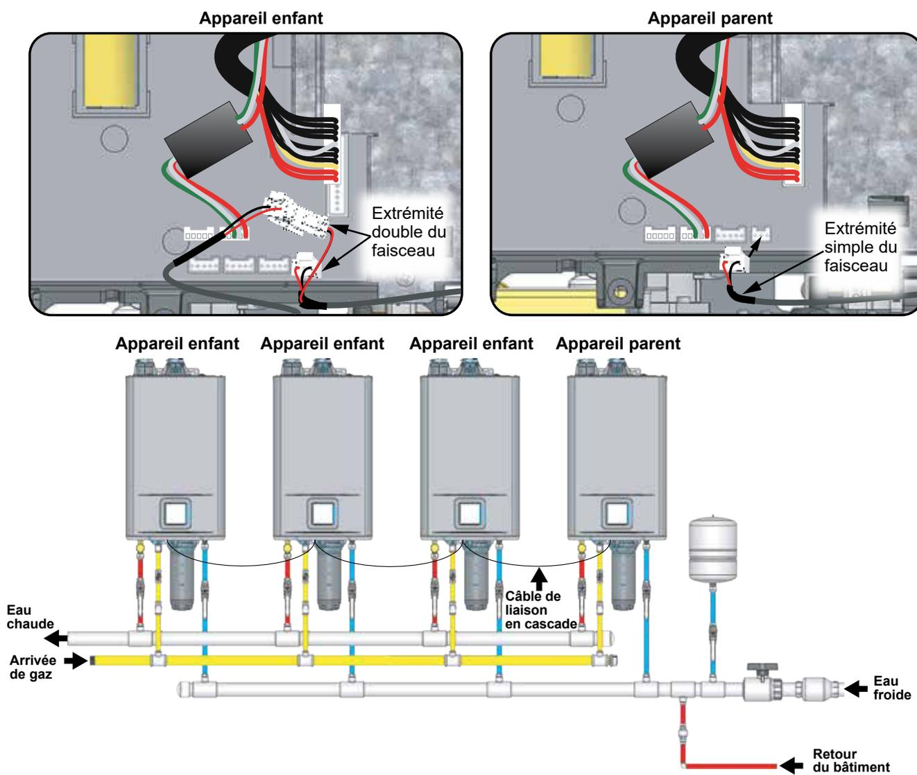
Figure 39 - Configuration en cascade de plusieurs appareils
