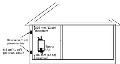
Figure 10 - Ouvertures directes sur l'extérieur. Deux ouvertures permanentes
