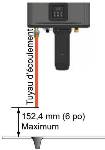
Figure 35 - Tuyau d'écoulement
