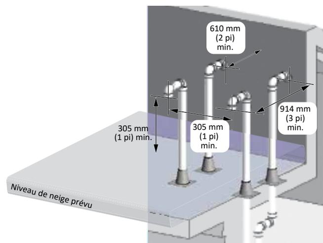
Figure 25 - Plusieurs bouches d'évacuation sur toit plat
