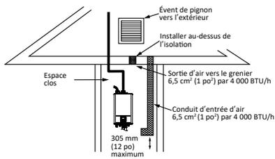
Figure 11 - Ouvertures par conduits verticaux
