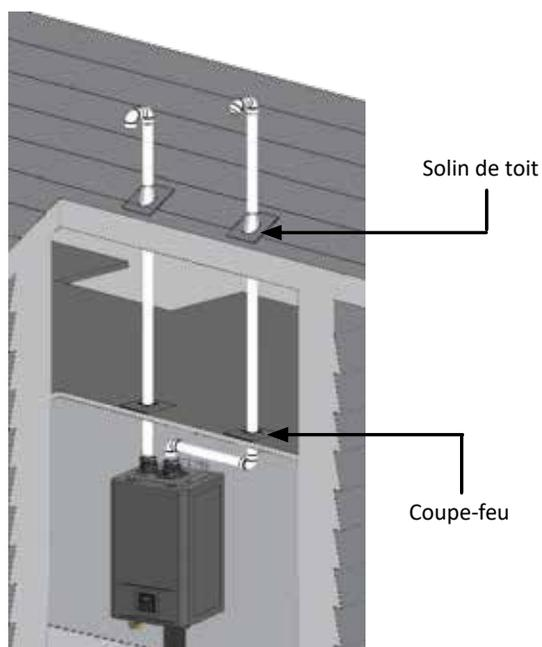
Figure 16 - Configuration des conduits d'une évacuation à ventouse
