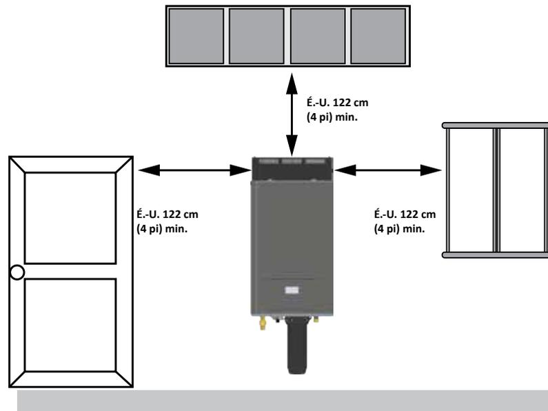
Figure 3 - Dégagements minimums de l'évacuation (évacuation à l'extérieur)
