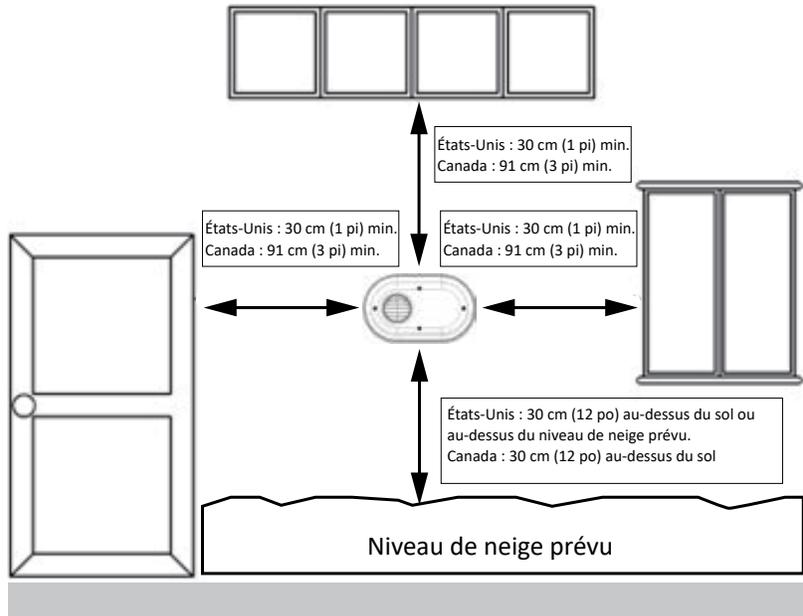
Figure 2 - Dégagements minimums de l'évacuation (à l'intérieur)
