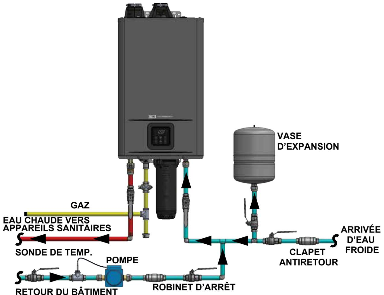
Figure 30 - Configuration typique d'une boucle de recirculation
