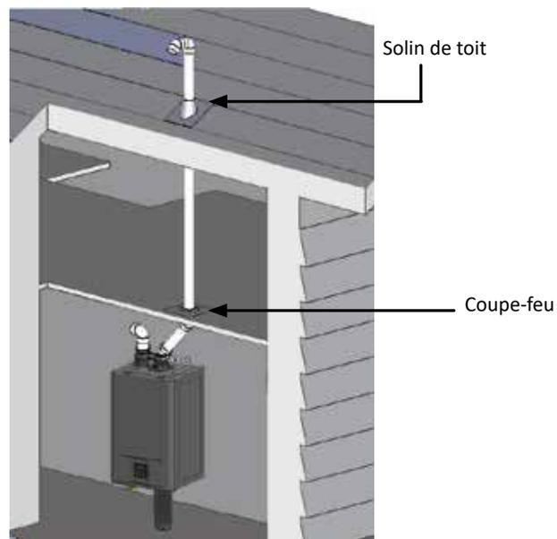
Figure 17 - Configuration des conduits d'une évacuation mécanique
