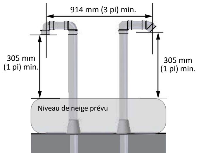
Figure 23 - Bouche d'évacuation sur toit plat
