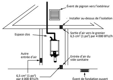
Figure 9 - Ouvertures directes sur l'extérieur
