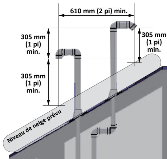
Figure 22 - Bouche d'évacuation sur toit en pente
