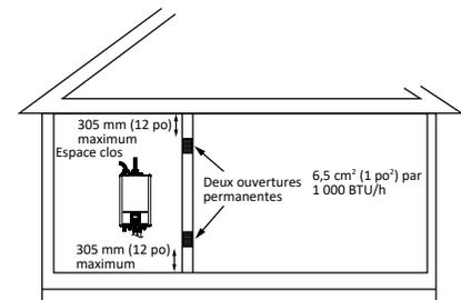
Figure 14 - Deux ouvertures permanentes
