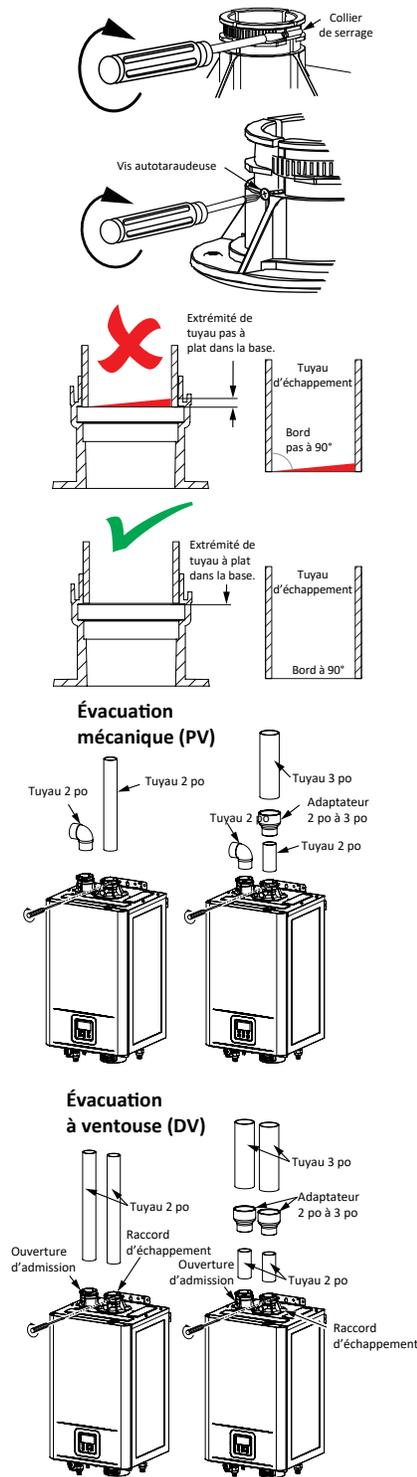
Figure 15 - Pose des tuyaux d'évacuation
