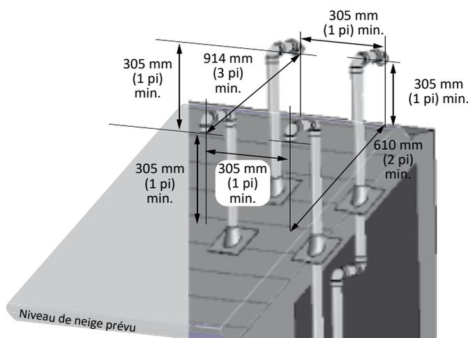
Figure 24 - Plusieurs bouches d'évacuation sur toit en pente
