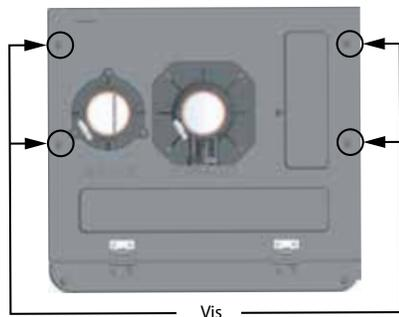
Figure 26 - Retirer les vis de la plaque supérieure.
