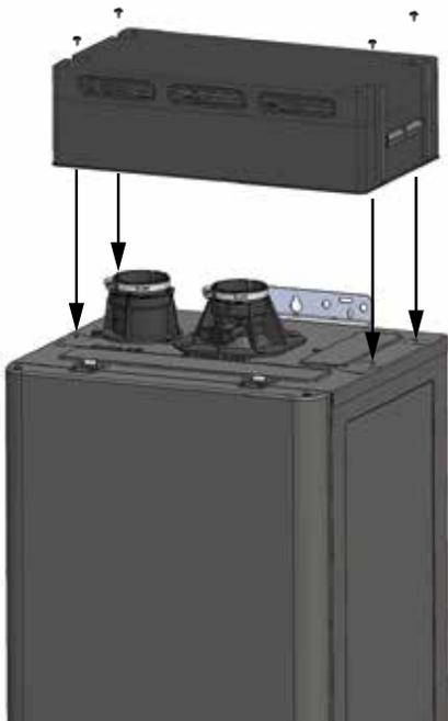
Figure 27 - Chapeau d'évacuation extérieur fixé avec des vis
